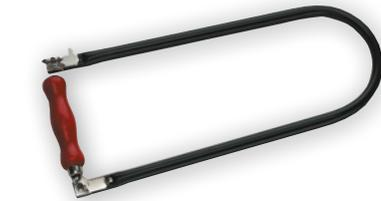
Laubsägebogen ohne Blatt, 280 mm Ausladung, aus Stahlrohr, kunststoffbeschichtet, Griff umlegbar
