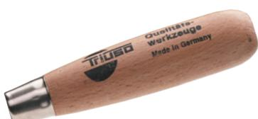
Die Kellen werden mit einem lackierten **Holzheft** oder Naturholzheft versehen. Damit dieser Griff beim Aufdruck (Anklopfen der Ziegelsteine zur Endpositionierung) nicht platzt, wird er mit einer konischen **Zwinge** ausgerüstet.
