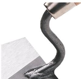
Die bei TRIUSO-Maurerkellen verwendeten **Angeln** sind gesenkgeschmiedet und weisen deshalb ein sehr feinkörniges Gefüge auf (Materialverdichtung), während bei Billigprodukten oft nur Massenrundstahl einfach abgeschrägt und zum Angelfüßchen gebogen wird.
