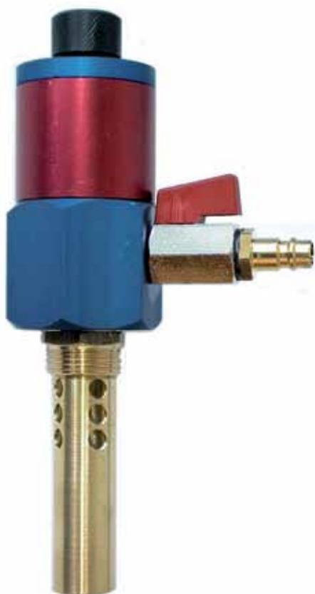
Die **ARIANA-Power-Vac-Pumpe** ist eine Doppelfunktions- Saug- und Druckpumpe, die mit Druckluft betrieben wird. Sie wird hauptsächlich zur Befüllung bzw. Entleerung von Schmier- und Kühlmittelbehältern verwendet. Diese Pumpe ist so konzipiert, dass sie schnell und problemlos an Standardfässern angebracht werden kann. Sie wird am Spundloch des Fasses eingeschraubt und an Druckluft angeschlossen. Ein Förderschlauch wird an der anderen Fassöffnung befestigt.
