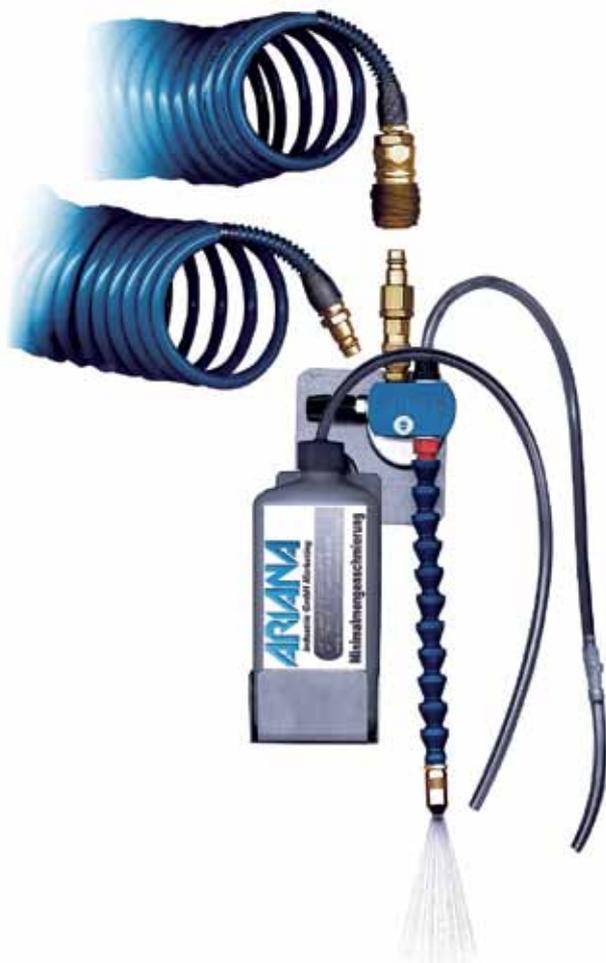
Das ARIANA-Mikro-System für Minimalmengenschmierung basiert auf einem Koaxialsprühkopf, der einen Rundstrahl mit Sprühwinkel erzeugt. Durch Verdrehen der Aufsatzkappe können unterschiedliche Sprühkegel für viele Anwendungsbereiche erzeugt werden. Der Koaxialsprühkopf wird pneumatisch betrieben und durch einen separaten, drucklosen Behälter mit dem Medium versorgt.
