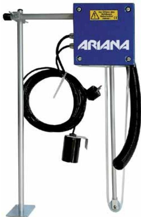
Der Schlauchskimmer wird über dem Flüssigkeitsbehälter mittels Magnetplatte befestigt, am besten auf der dem Flüssigkeitseinlauf gegenüberliegenden Seite. Die Grundplatte der Antriebseinheit muss ungefähr 300 mm über dem höchsten Flüssigkeitsniveau angebracht werden. An dem Auslaufstutzen wird der Schlauch angebracht, der in ein Absetzbecken geleitet wird.
